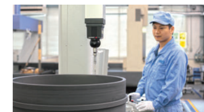
Inspection utilisant une machine à mesure 3D
